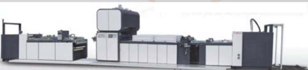
全自动高速开窗覆膜机(分切选配:热刀,链刀)
