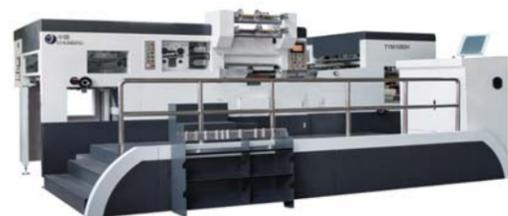
TYM1080HZ自动深压纹烫金模切机
